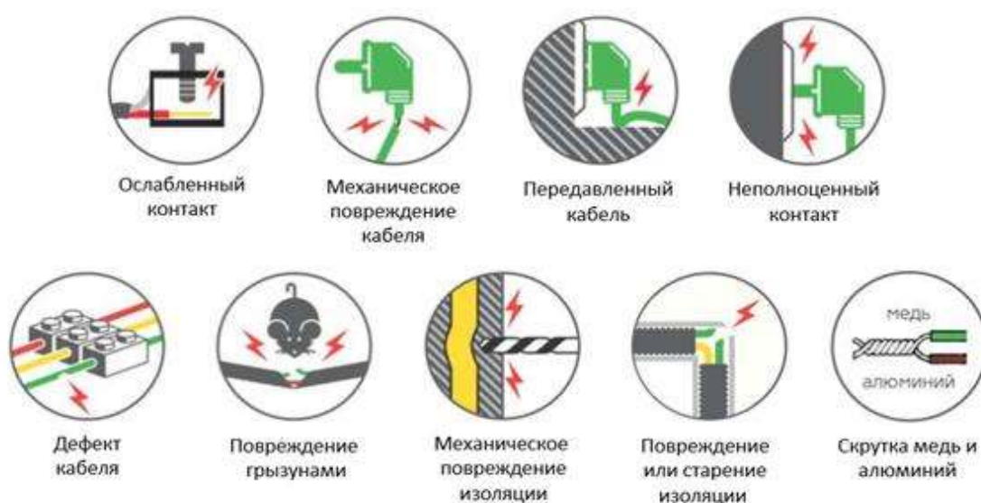
Рисунок 6. Возможные причины искрения в электропроводке
